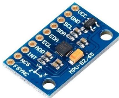
Figura 5 - Módulo Acelerômetro e Giroscópio 9 Eixos MPU-9250 GY-9250
