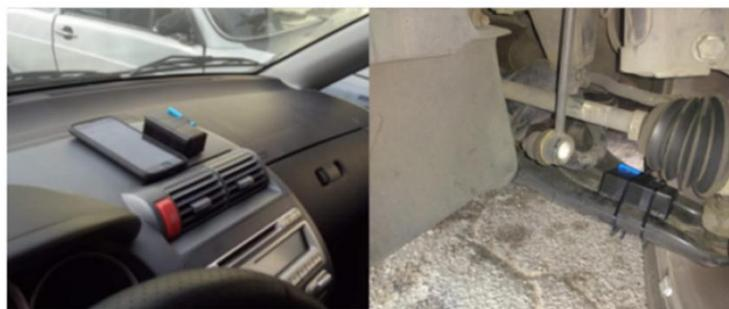
Figura 17 - Posicionamento dos módulos de acelerômetro
